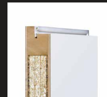
Schallschutzklasse 3 Türdicke ca. 48 mm | spezielle Schall- dämmeinlage | dreiseitige Türfalzdichtung SK3, RwP = 42 dB
