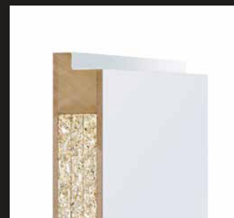
Schallschutzklasse 2 Türdicke ca. 43 mm | mehrlagige Vollspaneinlage | SK2, RwP = 37 dB
